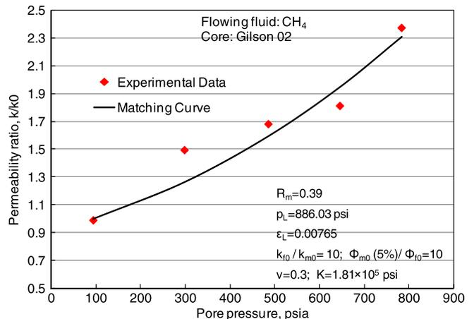
(d) Experimental data match for CH<sub>4</sub> for core Gilson 02.
